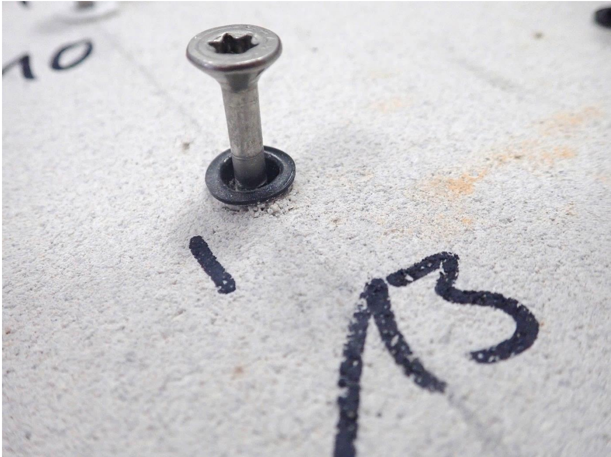
Abb. 4: Repräsentatives Beispiel für geprüften Dübelauszug [Probe 13 (3 PA Kalksandstein)]
